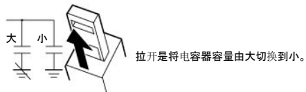
按下是将电容器容量由小切换到大。(标准出厂状态)
